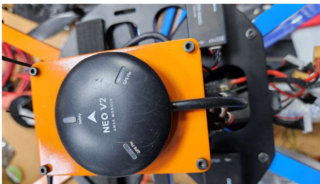
Рисунок 2.8—Фотография Neo V2 GNSS, показывающая его монтажное расположение на БПЛА.
